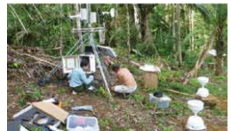
Installation d'une station micrométéorologique, à Réserve de la Trinité, en Guyane française.
